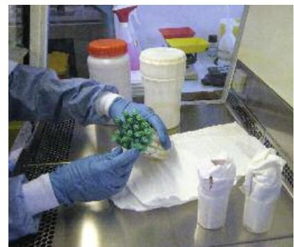
Fig. 3: toute manipulation de microorganismes lors de laquelle il peut y avoir transmission d'aérosols est effectuée dans un poste de sécurité microbiologique.
