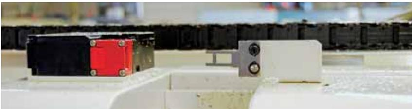
La machine ne peut fonctionner que lorsque la contre-pièce est insérée dans l'interrupteur de surveillance.
