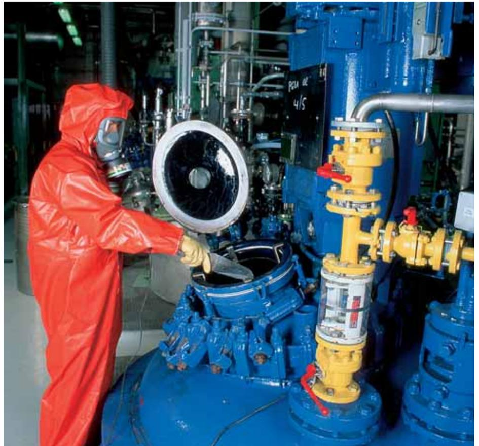
Charge d'un réacteur avec des poudres: cette illustration ne représente pas une solution idéale. Les solutions à privilégier sont techniques, comme le transfert pneumatique sous vide en système fermé qui permet d'éviter l'exposition du travailleur sans avoir recours à des équipements de protection individuelle.
