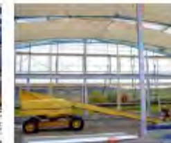
2 Vor dem Arbeiten mit Anseilschutz den Einsatz von Hubarbeitsbühnen prüfen.
