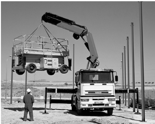
Bild 6 Fahrzeugkran: Lastwagenladekran mit einem Lastmoment von mehr als 400'000 Nm oder einer Ausladung von mehr als 22 m
