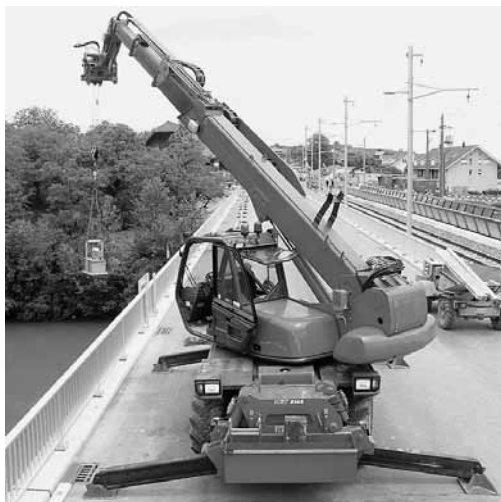
Foto 5 autogrù: sollevatore telescopico con argano
