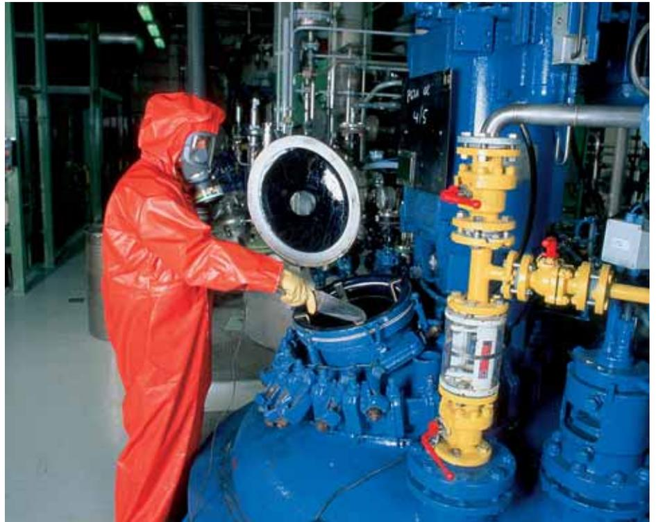
*Auffüllen eines Reaktors mit Pulver: Dieses Bild stellt keine ideale Lösung dar. Technische Vorrichtungen, wie geschlossene pneumatische Transportsysteme, sind vorzuziehen. Auf diese Weise ist der Arbeiter auch ohne persönliche Schutzausrüstung vor diesen Stoffen geschützt.*
