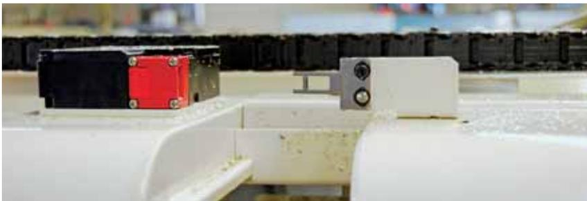
Die Maschine läuft erst, wenn das an der Schutzeinrichtung befestigte Gegenstück im Überwachungsschalter steckt.
