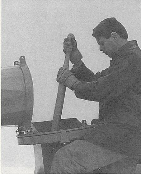
Die Forderung ist erfüllt, wenn zum Beseitigen bzw. Auflockern von Verstopfungen Werkzeuge wie Stöpsel aus Weichholz oder Kunststoff verwendet werden (Bild 15).
