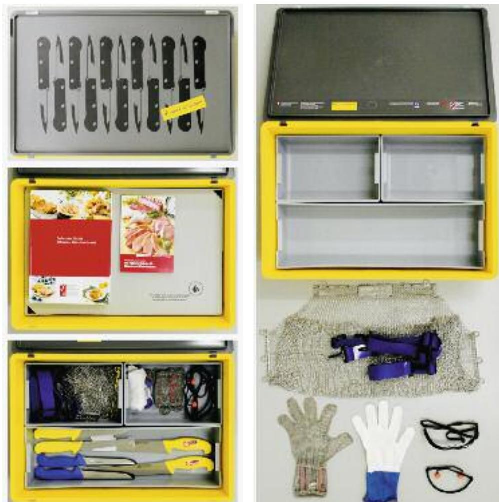
*Ce coffret compact permet de ranger et de transporter les couteaux de boucher, les équipements de protection individuelle et un livre d'apprentissage en respectant les règles d'hygiène et de sécurité.*
