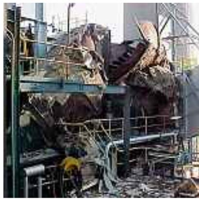
Explosion eines Druckgeräts (Kessel) in einer Raffinerie.
