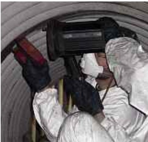
Magnetpulverprüfung Flammwellrohr, Rundnaht innen, an einem Doppel-flammrohrkessel.
