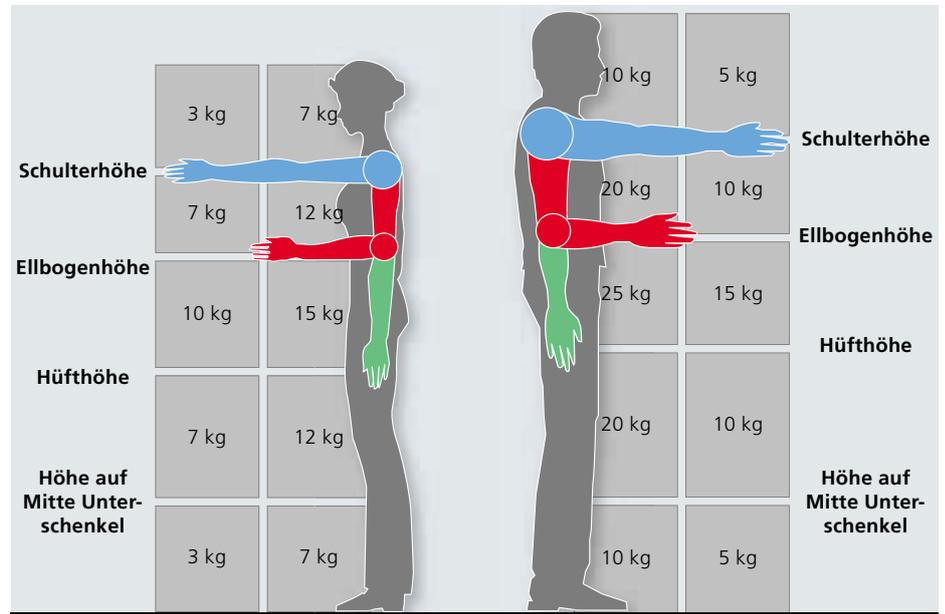
Abbildung 1: Maximale Belastung im Verhältnis zur Körperachse.
